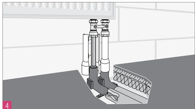
Рис. 10-10 Присоединение отопительного прибора с использованием присоединительного комплекта
