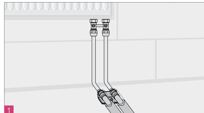
Рис. 10-4 Подключение отопительного прибора из пола через прямой блок шаровых кранов трубками из меди
