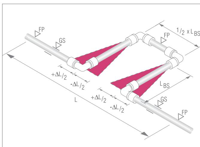
Рис. 16-2 П-образный компенсатор
