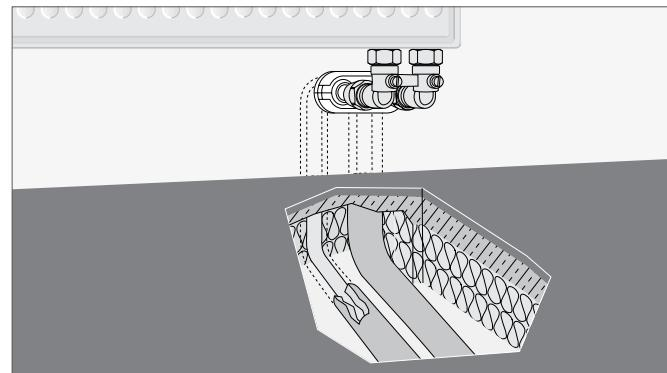
Рис. 15-7 Декоративная накладка на стене
