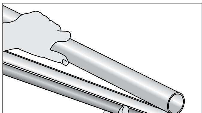
Рис. 13-8 Надевание на трубу
