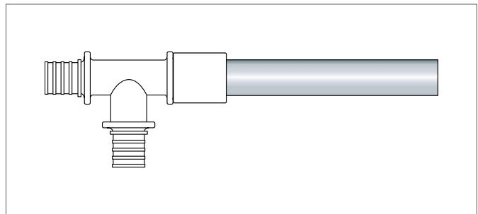
Рис. 10-11 Готовое соединение
