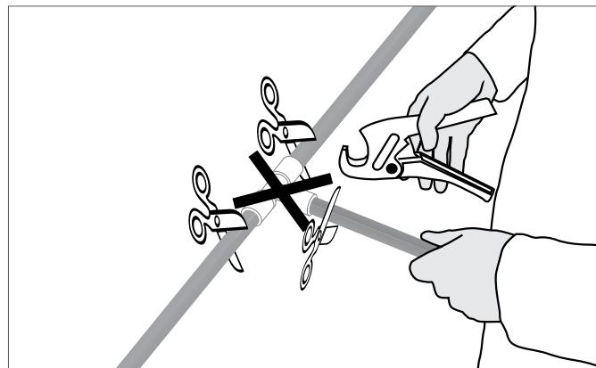
Рис. 11-1 Разборка соединения
