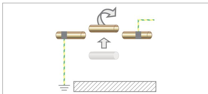
Рис. 17-12 Выравнивание электрических потенциалов при замене труб
