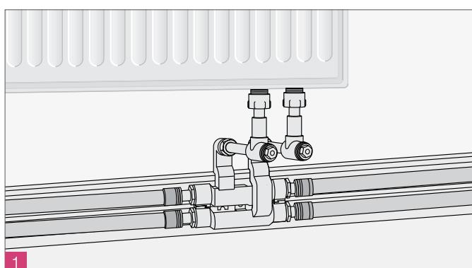
Рис. 16-4 Подключение отопительного прибора с помощью крестовины SL-Rautitan 16-12-16
