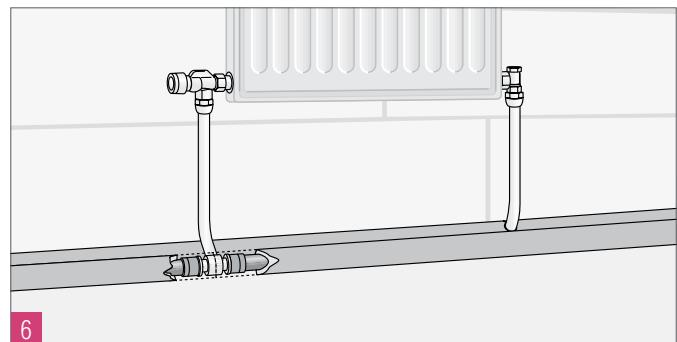
Рис. 10-14 Подключение отопительного прибора при помощи Т-образных присоединительных трубок Rautitan для разностороннего присоединения
