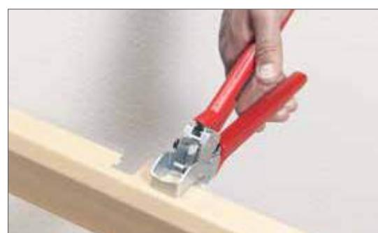
Рис.16-39 Вырезка прямоугольных отверстий в крышке плинтусных каналов
