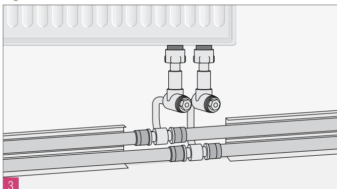
Рис. 16-8 Подключение отопительного прибора с помощью трубок в плинтусной разводке
