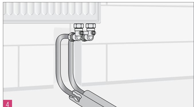
Рис. 11-8 Прямое подключение с помощью труб Rautitan stabil с отопительным прибором со встроенным вентилем
