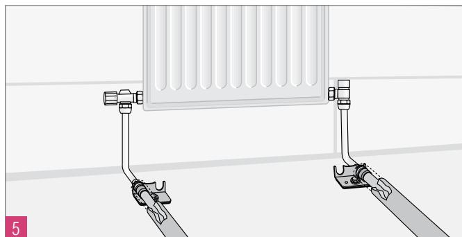
Рис. 10-12 Подключение отопительного прибора при помощи Г-образных присоединительных трубок Rautitan для разностороннего присоединения
