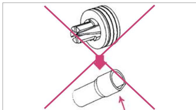
Рис. 9-3 Повреждение трубы из-за дефектной расширительной насадки
