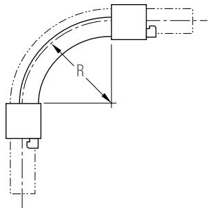
Рис. 12-6 Фиксаторы поворота (водоснабжение) – 90° и фиксаторы поворота (водоснабжение / отопление) (5 x Ø) – 90° для гнутья труб Ø 32
