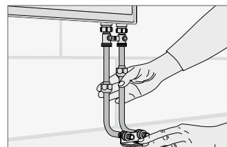
Рис. 13-7 Г-образные присоединительные трубы, вставленные в фиксирующий уголок
