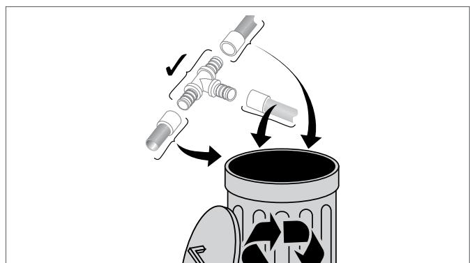
Рис. 11-4 Утилизация надвижных гильз и отрезков трубопроводов
