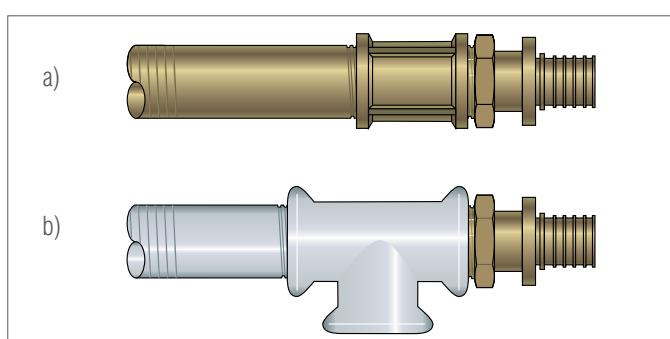
Рис. 6-13 Фитинги RAUTITAN с наружной резьбой для подключения к:
