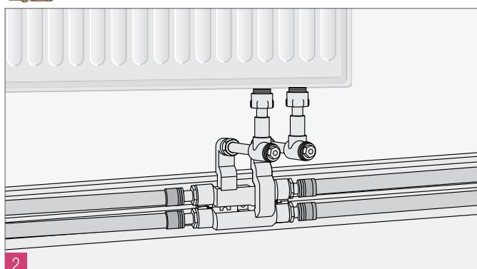
Рис. 16-6 Подключение отопительного прибора с помощью крестовины SL-Rautitan
