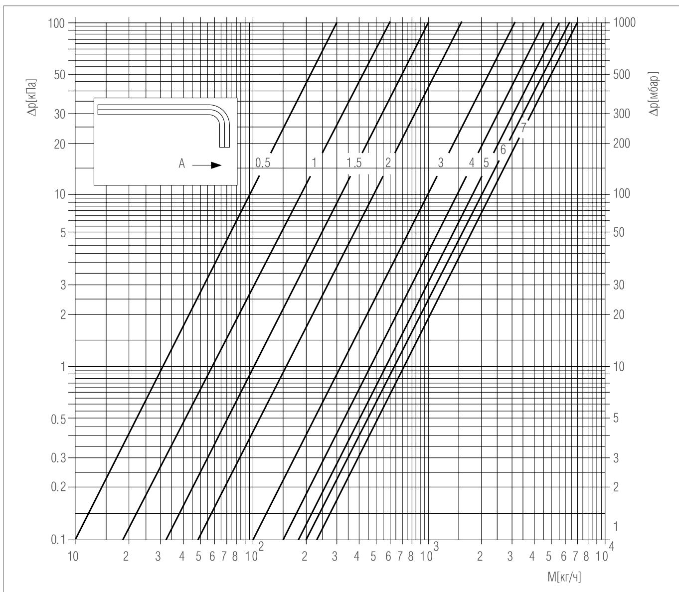
Рис. 15-15 Диаграмма распределения для регулировочного вентиля теплосчетчика
