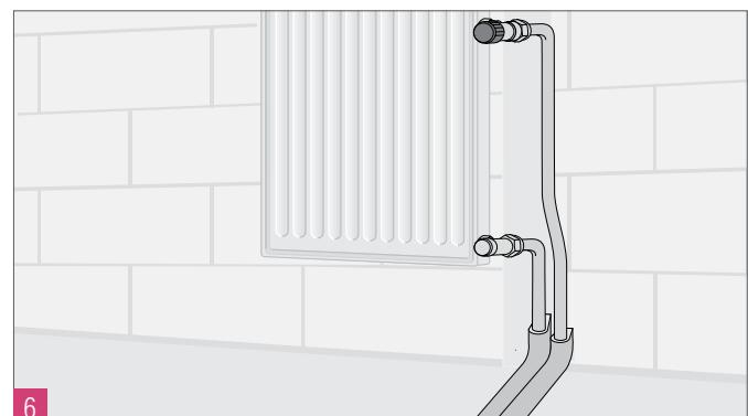
Рис. 11-12 Подключение к запорно-регулировочной арматуре радиатора с помощью переходника с наружной резьбой Rautitan MX
