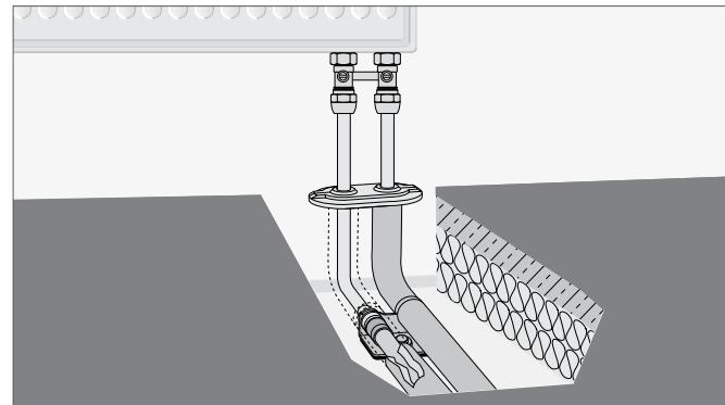
Рис. 15-6 Декоративная накладка на полу
