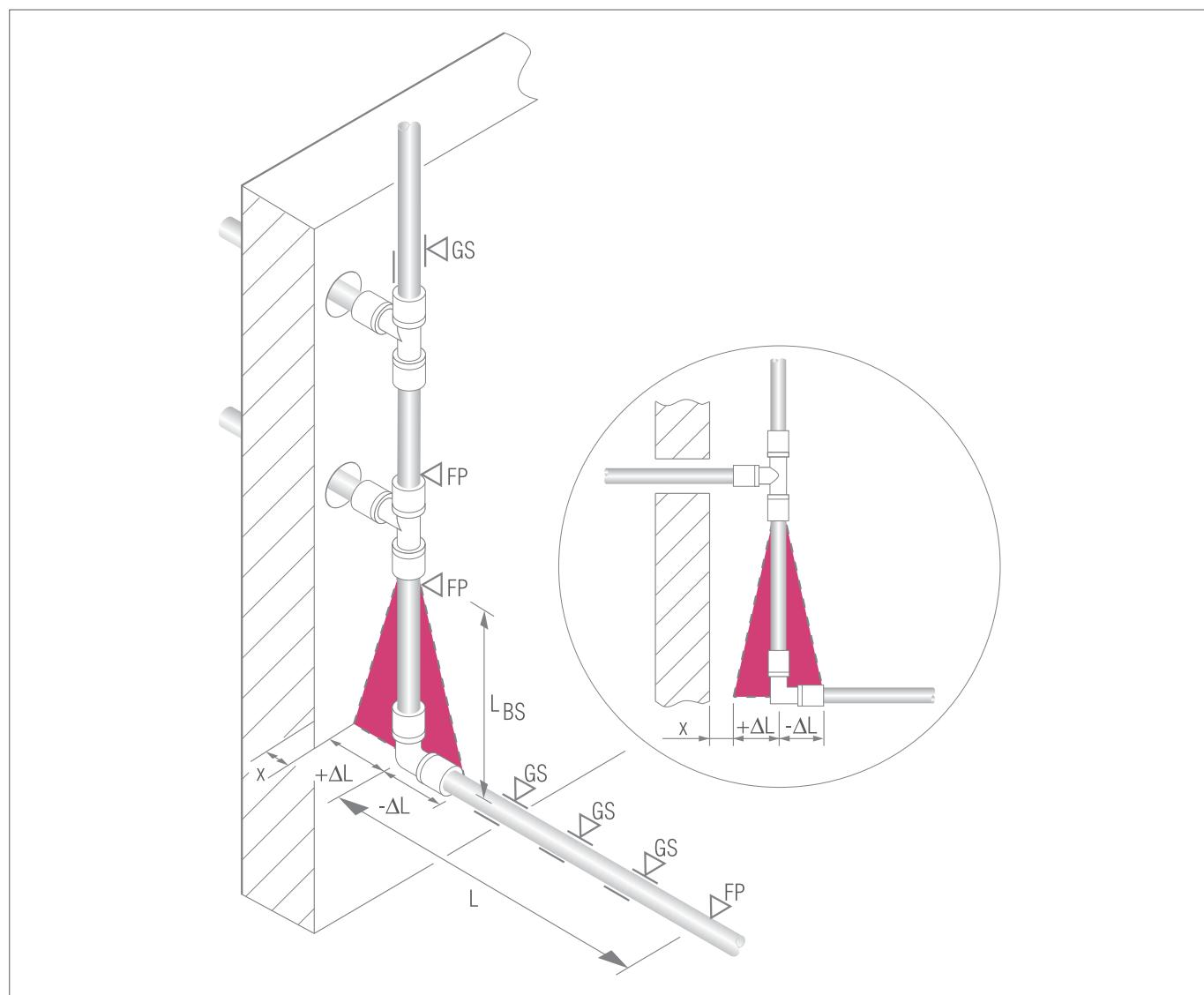
Рис. 16-1 Компенсатор
