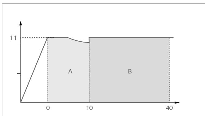
Рис. 7-1 Диаграмма гидравлического испытания для труб RAUTITAN stabil
