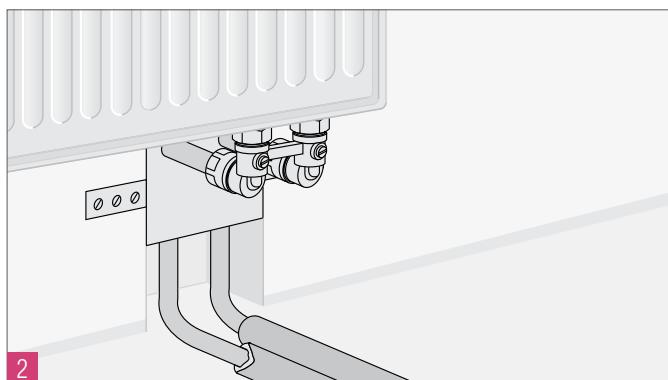
Рис. 11-4 Подключение отопительного прибора трубы Rautitan stabil при помощи присоединительного блока Rehau
