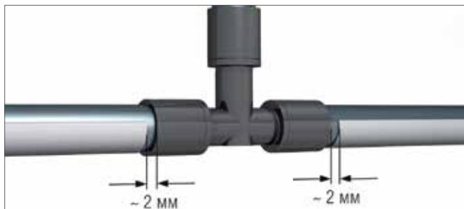
Рис. 13-5 Фиксирующий желоб недопустимо прокладывать поверх надвижных гильз RAUTITAN PX
