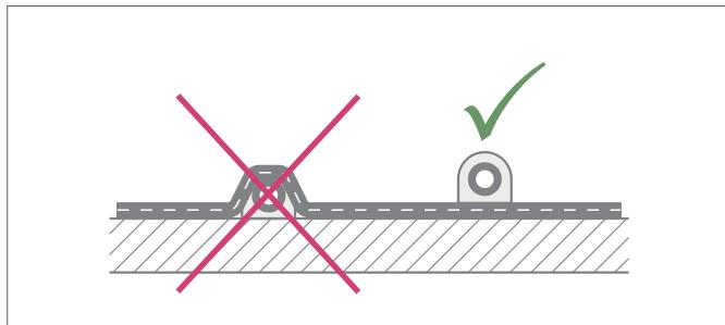
Рис. 17-9 Допустима укладка только поверх битумного слоя
