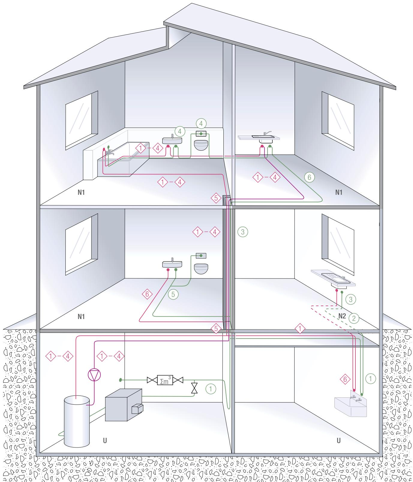
Рис. 18-3 Монтажные ситуации при изоляции трубопроводов
