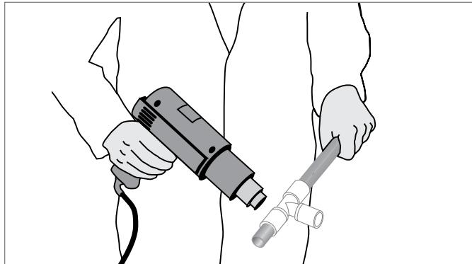
Рис. 11-2 Разогрев соединения перед разборкой
