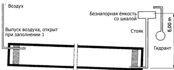
Между заполнением и испытанием трубопровода должно пройти достаточное время (1 час), чтобы оставшийся в трубопроводе после заполнения воздух мог постепенно выйти наружу.
