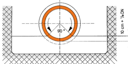
При проведении работ в зоне грунтовых вод нужно принять меры, чтобы не допустить их проникновения в опорную подушку.
