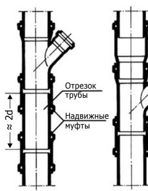
Установка дополнительного подключения
