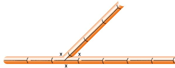
Установка колец или стержней для горизонтальных отводов:
