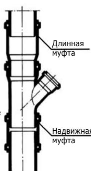
б) Вырежьте участок трубы равный длине фитинга плюс глубина вставки в раструб. Наденьте длинную муфту на трубу до упора и на другом конце трубы закрепите тройник надвижной муфтой. Затем гладкий конец длинной муфты задвиньте в раструб тройника (рис Б).
